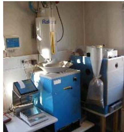
Fig. 3: Disponerea divizorului rotativ sub recipientul colector al unui prelevator de probe din camion reduce influența personalului operator și asigură o divizare reprezentativă. (Foto: Rationel Kornservice)
