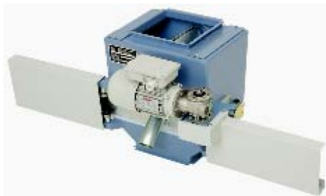
Fig. 1: La prelevatorul pe conducta de cădere, un motor deplasează fanta de prelevare a probei pe toată suprafața conductei și asigură astfel o proporție de colectare reprezentativă (Foto: Rationel Kornservice).
