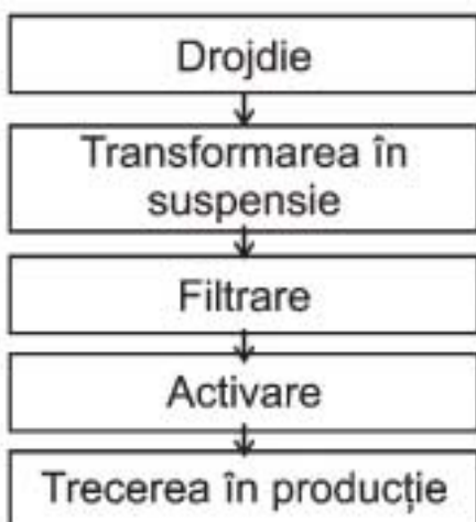
Fig. 1. Schema tehnologică de pregătire a drojdiei pentru utilizarea în producție
